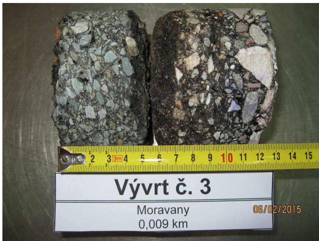
Foto č. 3 – Detail vývrtu č. 3
