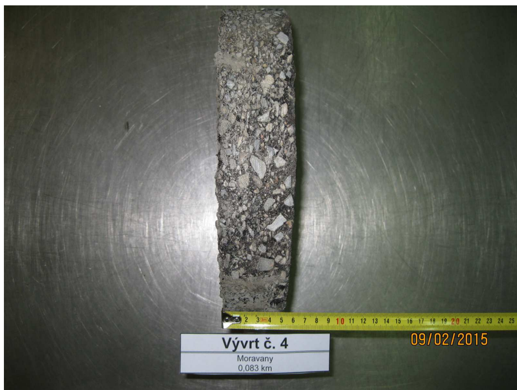
Foto č. 4 – Detail vývrtu č. 4 (vrtaná sonda VS 1)
